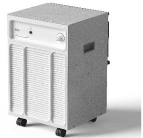
Hygrostatregler, ohne Installation steckerfertig und variabel einsetzbar, mobil mit 4 Lenkrollen (2 davon arretierbar). Polymerluftfilter, kontinuierlicher Abfluss, Überlaufsicherung mit rotem Licht auf der Front. Umweltfreundliches Kältemittel, reduzierter Stromverbrauch, modifizierter Frontgrill für einfachere Wartung, frostfreie Einheit.
